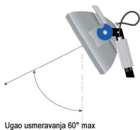
Zabranjen prostor za postavljanje rasvete da bi se izbegao odsjaj ka glavnoj kameri
